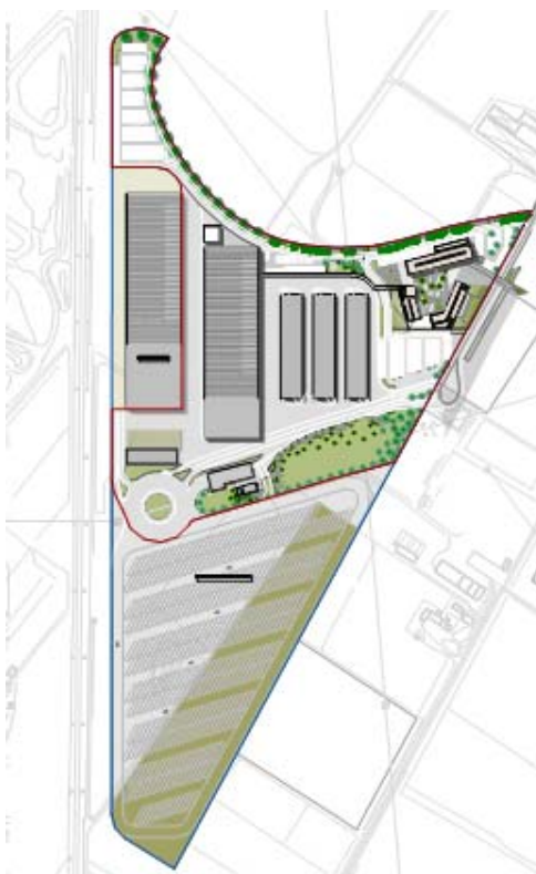
Figura 31. Planimetria del deposito comprensiva del futuro ampliamento
