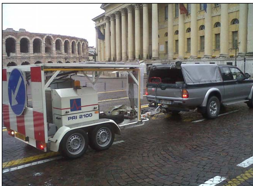
Figura 33. La strumentazione FWD impiegata a Verona per la valutazione delle pavimentazioni stradali esistenti
