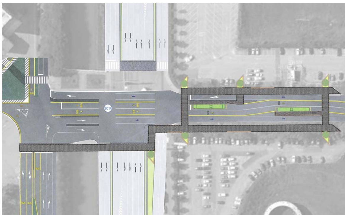
Figura 68 – Planimetria sistemazioni di superficie sottopasso Città di Nîmes
